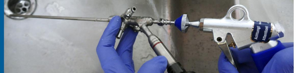
Das Endoskop 20 Sekunden oder gepulst mit 5 Druckstößen (2,5 - 4 bar) mit einer Reinigungspistole durchspülen.
