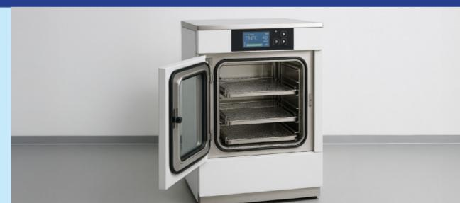
Die Sterilisation des Endoskops erfolgt mittels fraktioniertem Vorvakuum-Verfahren gemäß ISO 17665 unter Berücksichtigung der jeweils geltenden nationalen Anforderungen. Die Temperaturhaltezeit beträgt 3 Minuten bei 134 °C, die Evakuierung erfolgt dreifach. Die Trocknungszeit liegt bei 10–20 Minuten. Die maximale Temperatur darf 138 °C nicht überschreiten.
