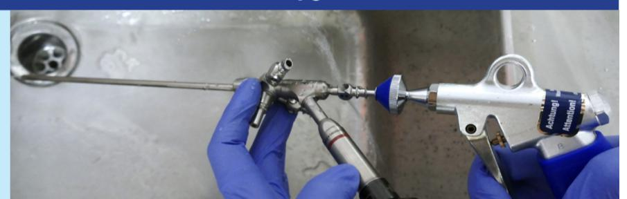
Das Endoskop mindestens 20 Sekunden gründlich mit Leitungswasser abspülen. Arbeitskanal 20 Sekunden oder gepulst mit 5 Druckstößen (2,5 - 4 bar) mit einer Reinigungspistole durchspülen.
