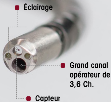
Extrémité distale atraumatique biseautée de diamètre 6,6 Ch.
